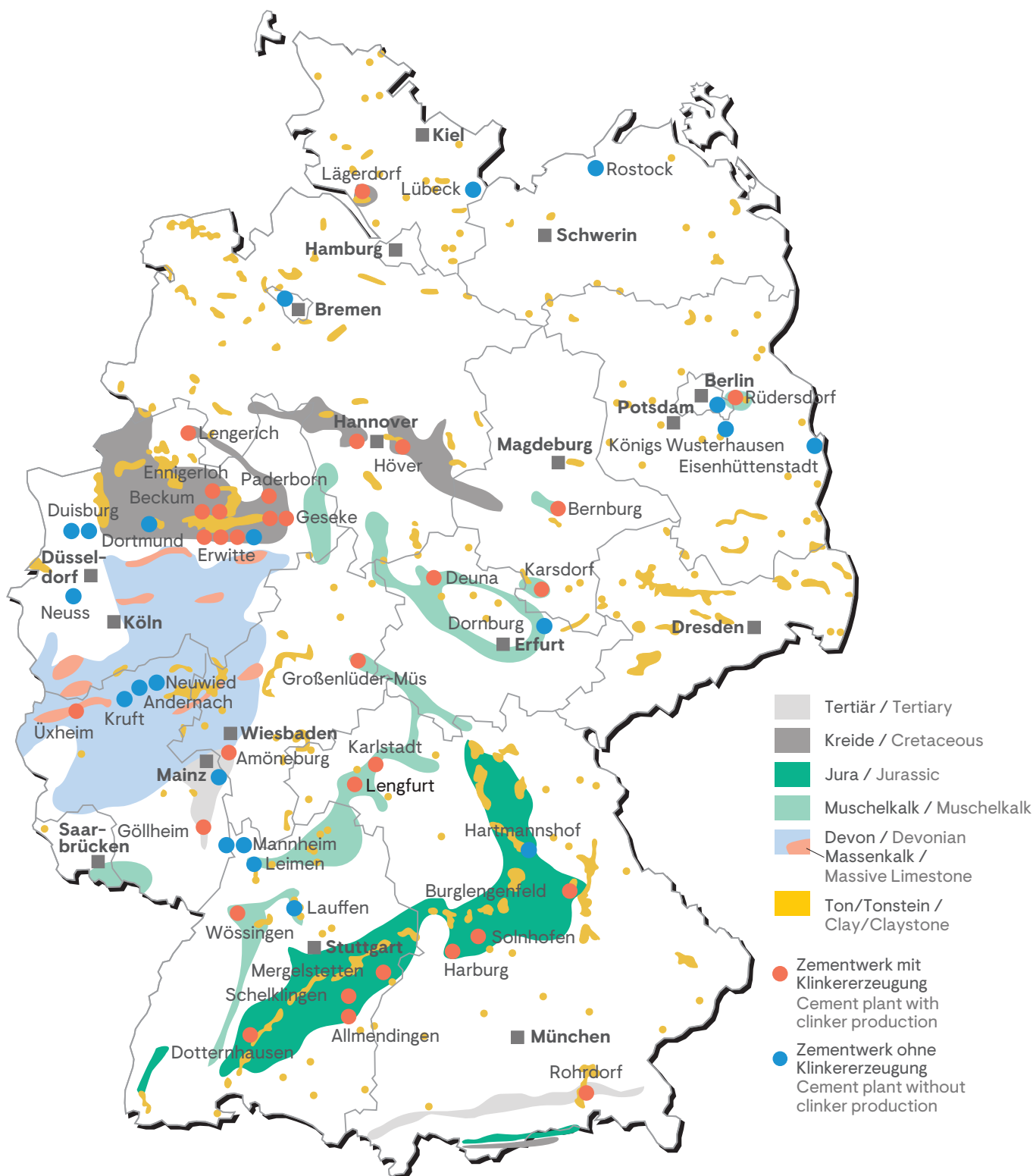
Bild 1-2 Zementwerke in der Bundesrepublik Deutschland im Jahr 2024 Fig. 1-2 Cement works in the Federal Republic of Germany in the year 2024
