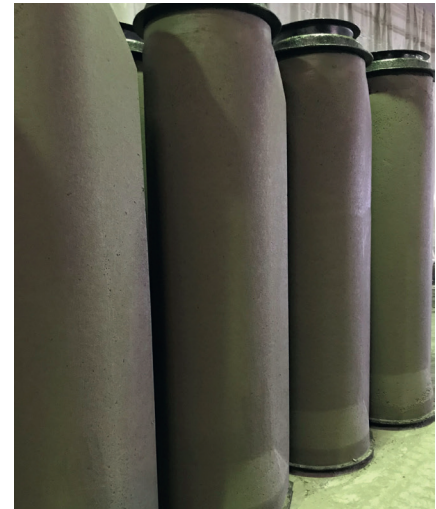
Bild 1: Anwendung des Versuchszements aus gemeinsamer Mahlung in der Fertigung von Betonrohren. Quelle: Betonwerk Bieren
