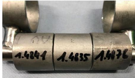
Abbildung 29. Ein Bild der Stahlproben, die auf die Wärmerohre auf der Kalzinier- und Verbrenner-Seite geschoben wurden, für die Untersuchung des Einflusses des Langzeitverhaltens als Wärmerohrbehältermaterial und die Einflüsse der jeweiligen Anlagenseite auf das Material.
