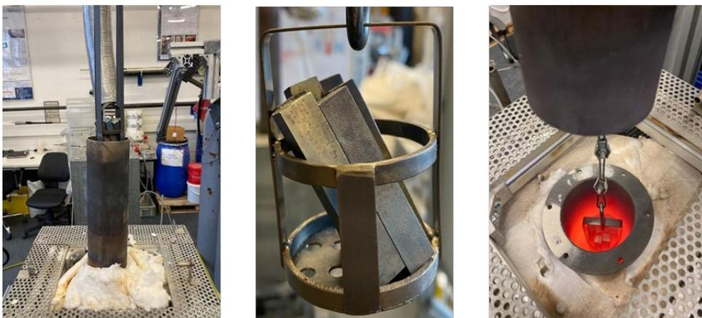
Abbildung 30. Bilder des Versuchsaufbau (links), Proben im Probenhalter (mitten) und Proben in der heißen Wirbelschicht (rechts).
