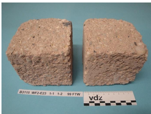
Bild 7-33 Beton WF2-E23 – CEM II/C-M (Q1-LL2), 1 FTW/Tag, Würfel 1 und 2 nach 99 FTW im Würfelverfahren
