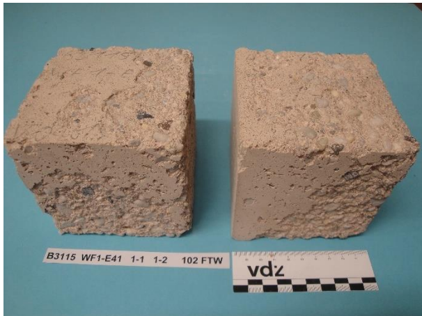
Bild 7-25 Beton WF1-E41 – CEM VI (S1-Q2), 1 FTW/Tag, Würfel 1 und 2 nach 102 FTW im Würfelverfahren
