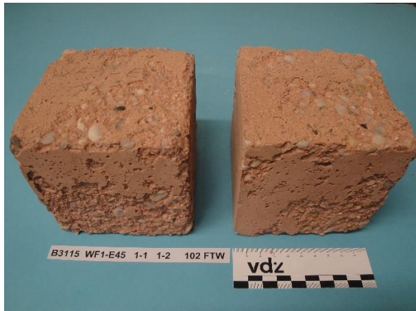
Bild 7-29 Beton WF1-E45 – CEM VI (S1-Q3), 1 FTW/Tag, Würfel 1 und 2 nach 102 FTW im Würfelverfahren
