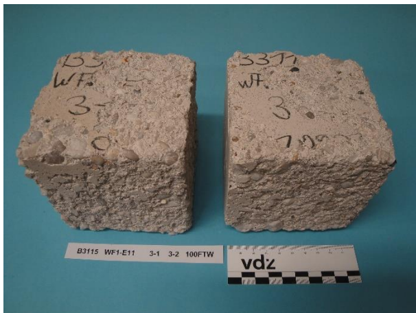
Bild 7-7 Beton WF1-E11 – CEM II/C-M (S2-LL2), 2 FTW/Tag, Würfel 1 und 2 nach 100 FTW im Würfelverfahren
