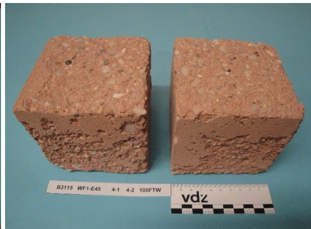
Bild 7-32 Beton WF1-E45 – CEM VI (S1-Q3), 2 FTW/Tag, Würfel 3 und 4 nach 100 FTW im Würfelverfahren
