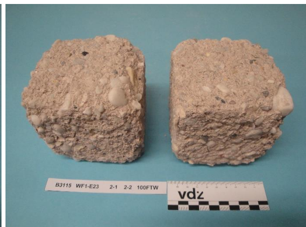
Bild 7-10 Beton WF1-E23 – CEM II/C-M (Q1-LL2), 1 FTW/Tag, Würfel 3 und 4 nach 99 FTW im Würfelverfahren
