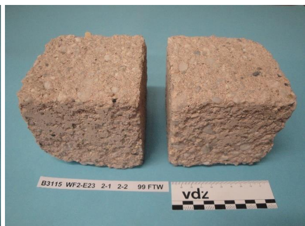
Bild 7-34 Beton WF-E23 – CEM II/C-M (Q1-LL2), 1 FTW/Tag, Würfel 3 und 4 nach 99 FTW im Würfelverfahren
