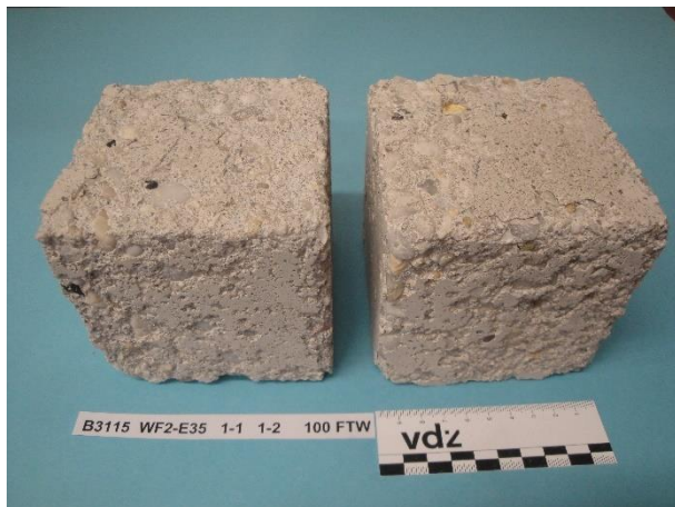
Bild 7-37 Beton WF2-E35 – CEM VI (S2-LL2), 1 FTW/Tag, Würfel 1 und 2 nach 100 FTW im Würfelverfahren
