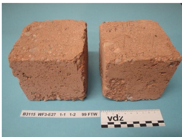
Bild 7-39 Beton WF3-E27 – CEM II/C-M (Q3-LL2), 1 FTW/Tag, Würfel 1 und 2 nach 99 FTW im Würfelverfahren
