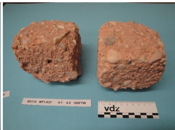
Bild 7-16 Beton WF1-E27 – CEM II/C-M (Q3-LL2), 2 FTW/Tag, Würfel 3 und 4 nach 100 FTW im Würfelverfahren
