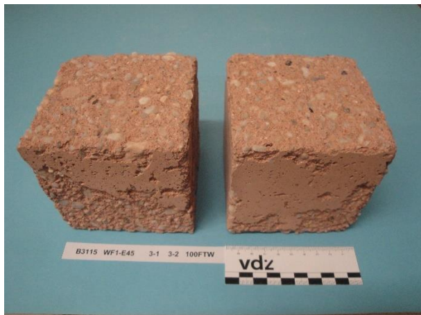
Bild 7-31 Beton WF1-E45 – CEM VI (S1-Q3), 2 FTW/Tag, Würfel 1 und 2 nach 100 FTW im Würfelverfahren
