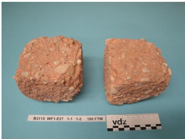
Bild 7-13 Beton WF1-E27 – CEM II/C-M (Q3-LL2), 1 FTW/Tag, Würfel 1 und 2 nach 98 FTW im Würfelverfahren
